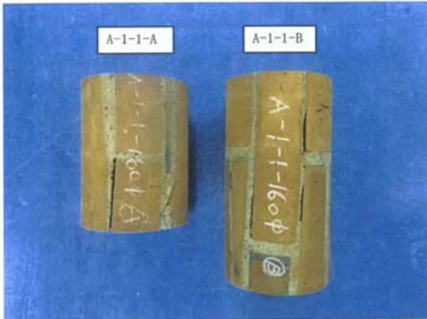
写真-16 整形・研磨後の供試体 [れんがコア(要素)] (圧縮強度試験用)
