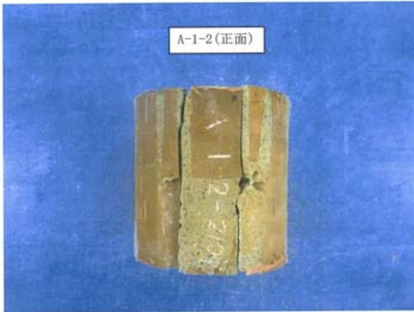
写真-51 目地モルタルの破壊状況 (正面) [A-1-2]
