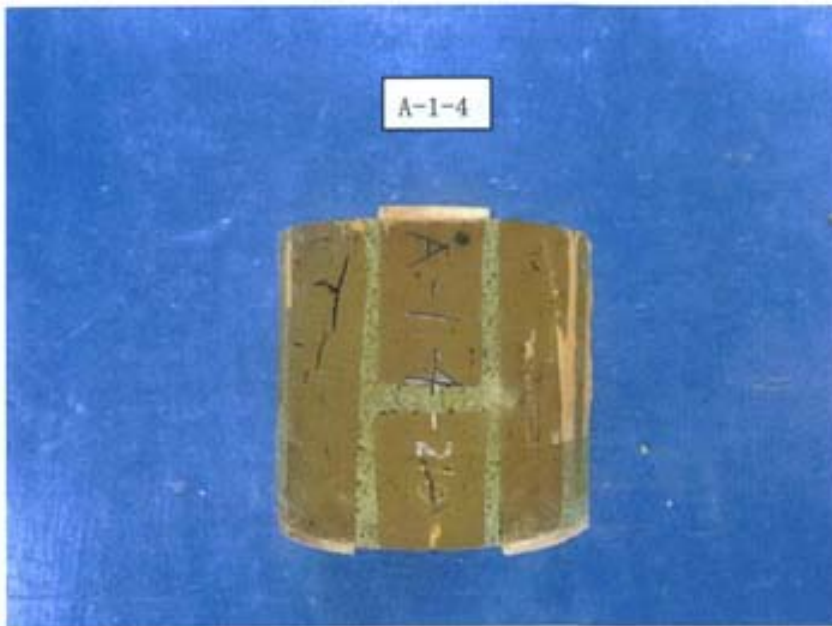
写真-26 整形・キャッピング後の供試体 [れんがコア(要素)] (目地モルタルのせん断強度 試験用)
