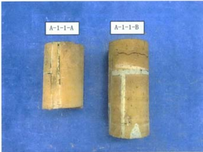
写真-2 供試体の外観 [れんがコア(要素)] (圧縮強度試験用)
