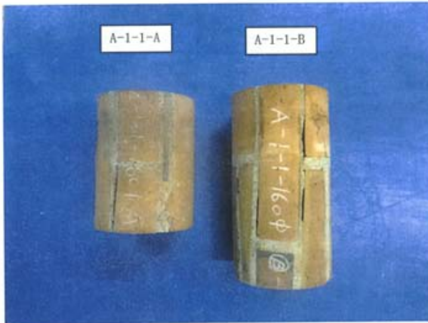
写真-40 圧縮強度試験後の破壊状況 (正面) [A-1-1-A 及び A-1-1-B]
