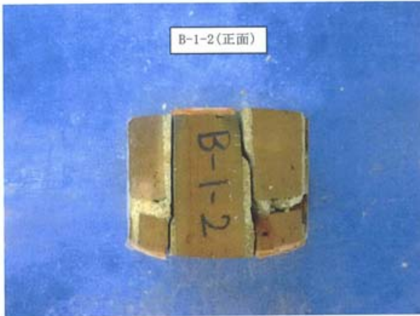
写真-75 目地モルタルの破壊状況 (正面) [B-1-2]
