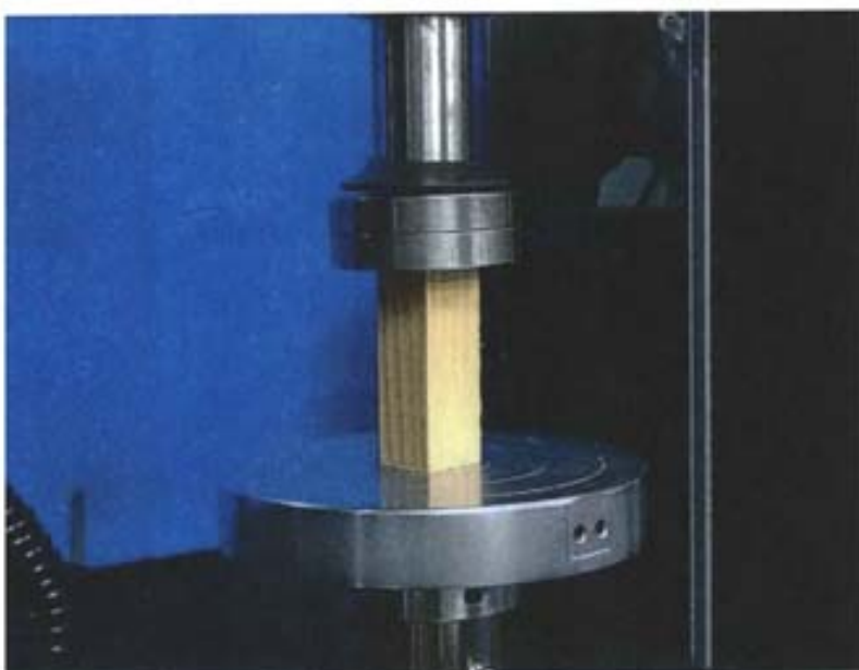
写真-5 縦圧縮試験状況
