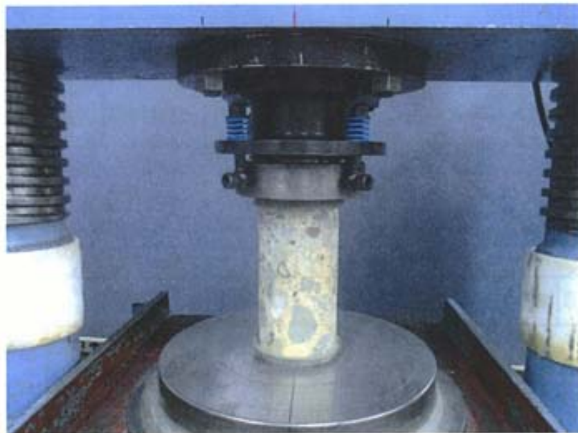
写真-3 圧縮強度試験状況の一例 [A棟基礎 No. 1]
