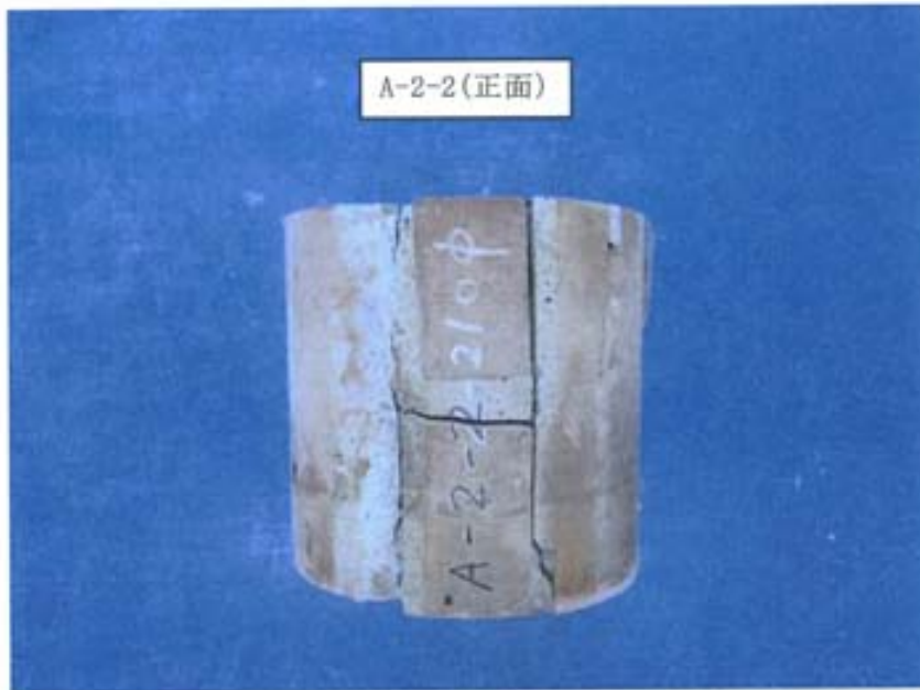
写真-66 目地モルタルの破壊状況 (正面) [A-2-2]
