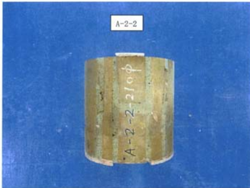
写真-29 整形・キャッピング後の供試体 [れんがコア (要素)] (目地モルタルのせん断強度 試験用)
