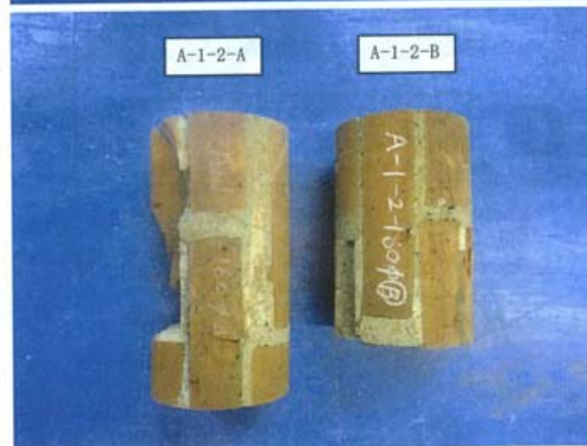
写真-42 圧縮強度試験後の破壊状況 [A-1-2-A 及び A-1-2-B]
