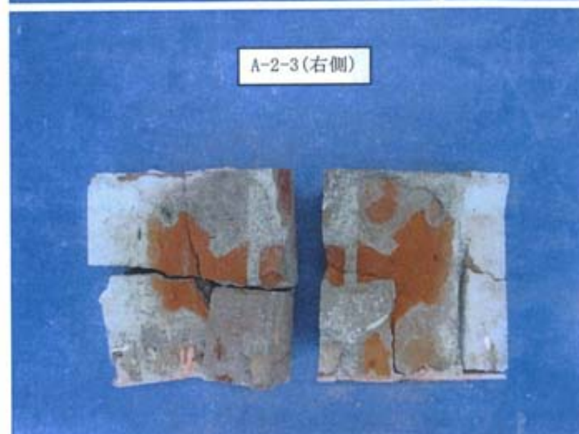
写真-71 目地モルタルの破壊状況 (写真-69 右側) [A-2-3]
