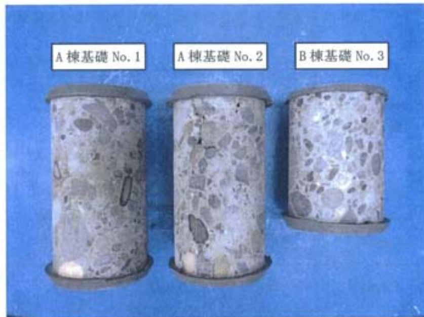
写真-2 整形・キャッピング後の供試体の外観
