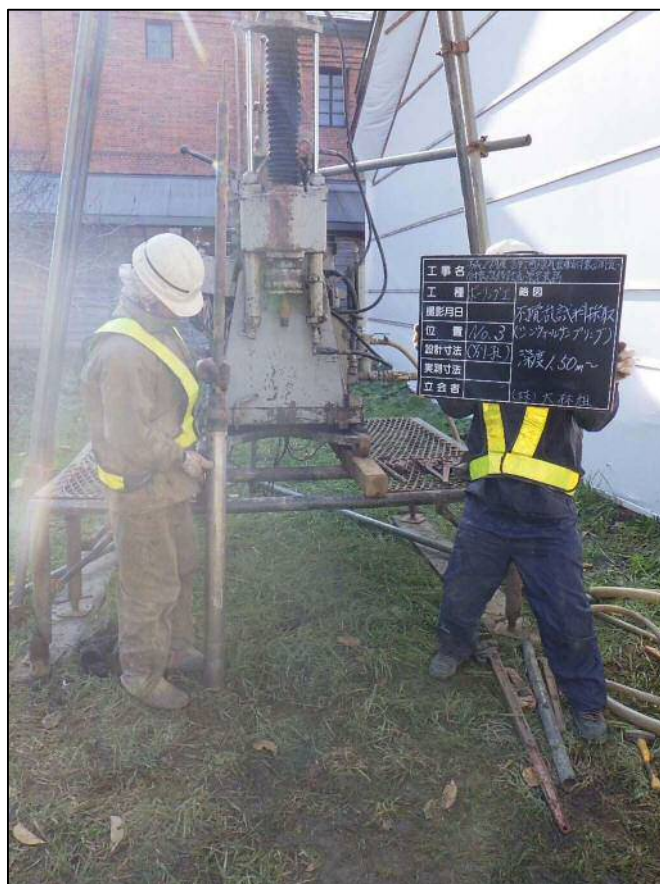
(別孔) 不攪乱試料採取(シンウォールサフリング) 深度 10.00m~
