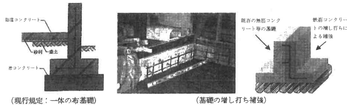
付図2.3 基礎の補強方法
