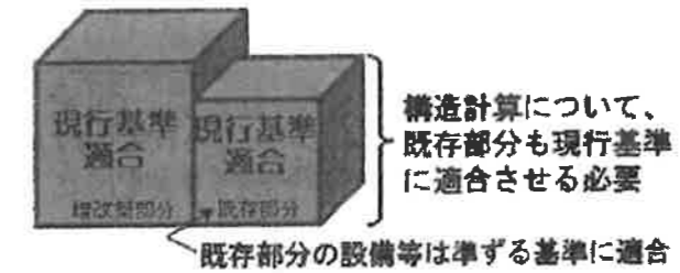
付図2.5 規模制限なし増改築の場合の規定の適用
