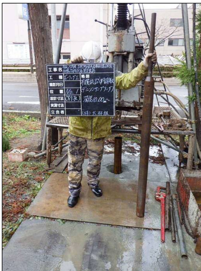
(別孔)不攪乱試料採取(デニソンサブリック)
