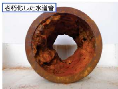
破損して漏水した管
