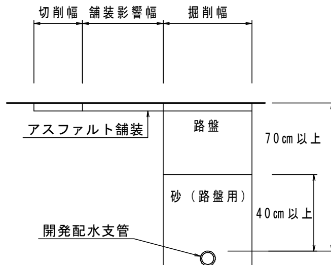
図5 開発配水支管の埋設深さ（第17条第2項第5号関係）
