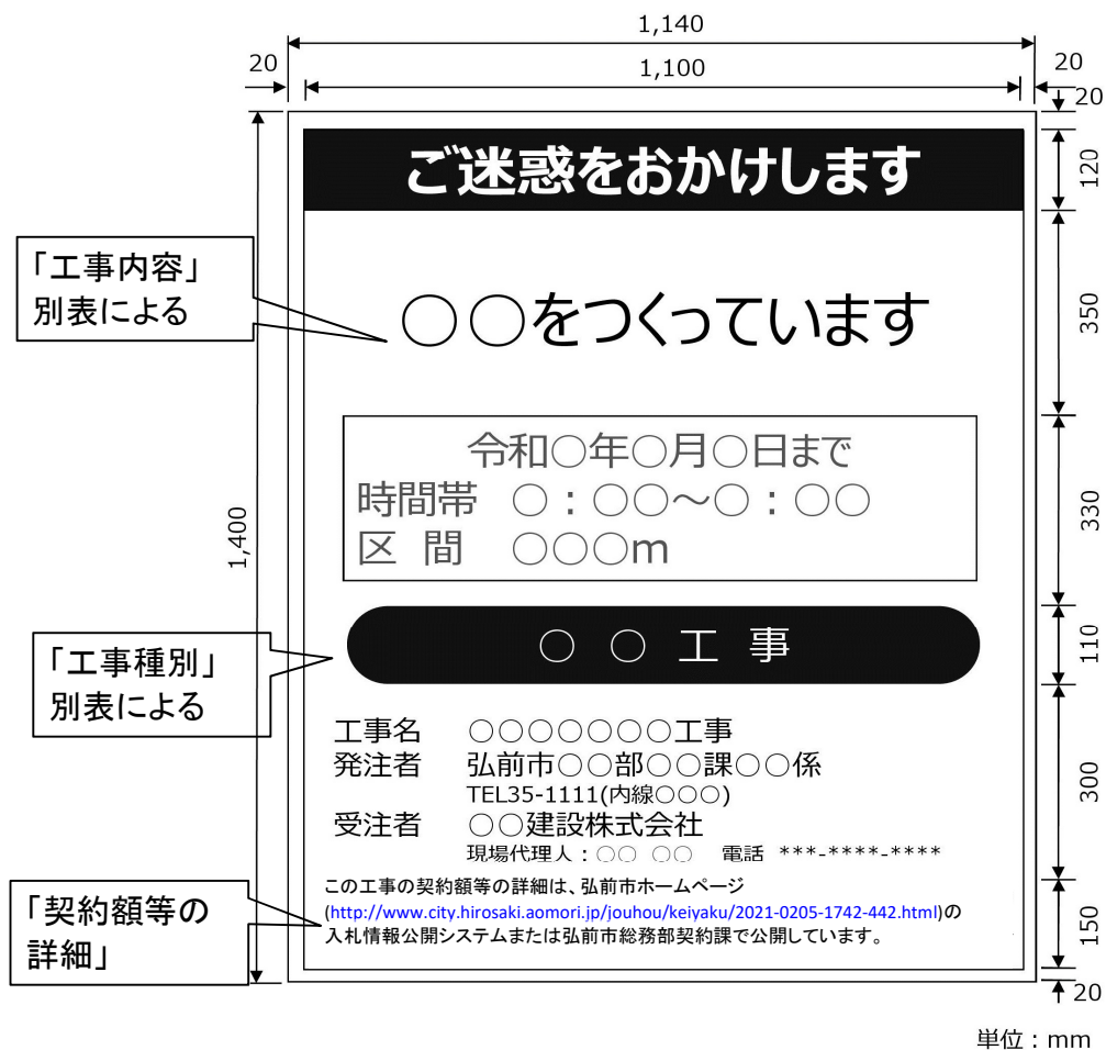
工事名標示板（記載例）
