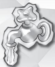
水抜き栓は水を抜くときは全閉、使用するときには全開になるよう、しっかりと確認した上で操作してください。
