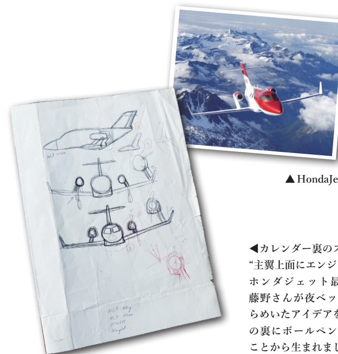
Honda独自の主翼上面エンジン配置(OTWEM) OTWEM : Over-The-Wing Engine Mount
