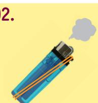
操作レバーを押し下げ、輪ゴム等により下げた状態を固定します
