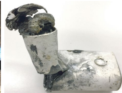
【写真】(上) 焼けてしまったリサイクル工場の建屋・設備 / (左下) 発火原因となった掃除機・(右下) 加熱式タバコ(ともにリチウムイオン電池内蔵)
