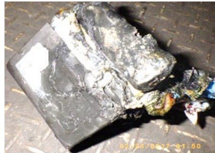
【写真】(上) 焼けてしまったリサイクル工場の建屋・設備 / (左下) 発火原因となった掃除機・(右下) 加熱式タバコ(ともにリチウムイオン電池内蔵)
