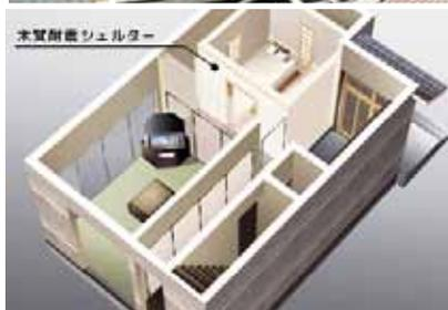
耐震シェルターを木造家屋の1階に設置し、万一地震により家屋が倒壊しても、中にいる人の安全を確保します。
