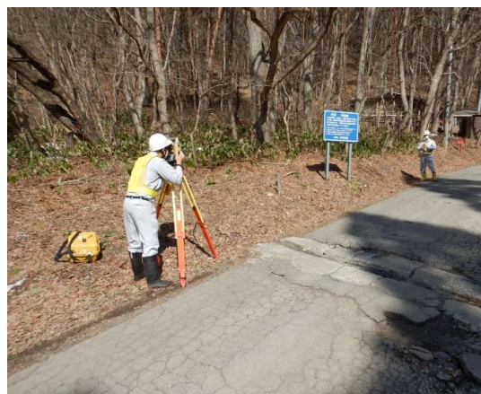
測量風景 反射鏡(プリズム)に光を反射させて 位置を測定する。
