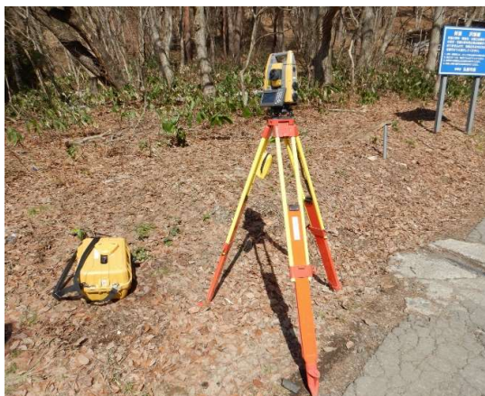
測量機器(トータルステーション) (角度、距離を測定)
