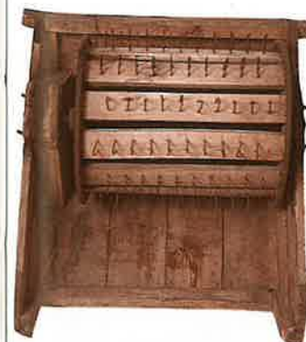
●足踏脱穀機 千刈は、扱きよりずっと能率的な脱穀機
